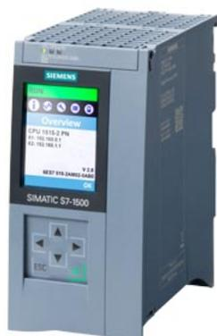
SIMATIC S7-1500, CPU 1515-2 PN, unité centrale avec 500Ko de mémoire de travail pour le programme et 3Mo pour les données, 1ère interface : PROFINET IRT avec commutateur 2 ports, 2ème interface: PROFINET RT, performance sur bit 30 NS, carte mémoire SIMATIC nécessaire
